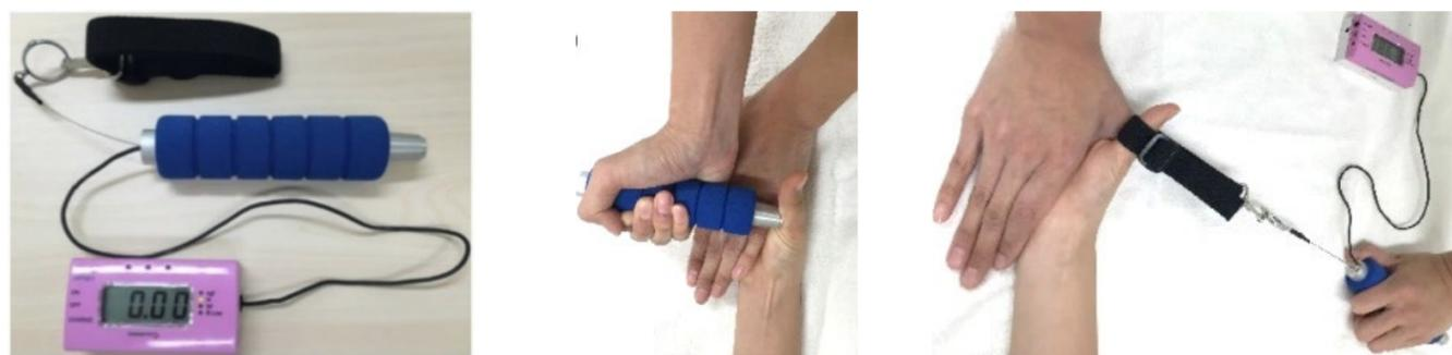
一般的な筋力測定には握力, つまみ力の計測が挙げられますが, 本研究では各指の各運動方向の筋力測定が可能な機器を開発し, 臨床応用を試みています。また手の機能評価としてパフォーマンス能力の検査バッテリーの開発に取り組んでいます。
